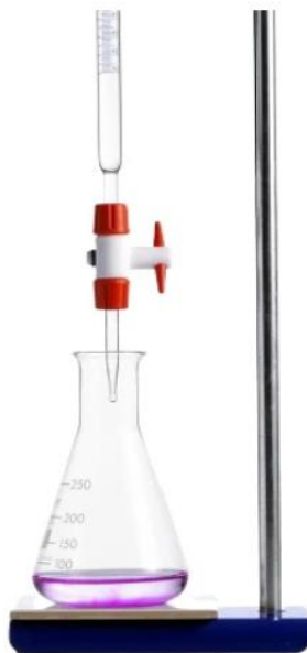
Şekil 7. Titrasyon düzeneği ve menüsküsün okunması
