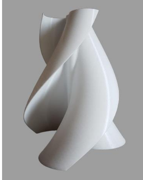
Şekil 2.2. – 3D yazıcıda üretilen 3 kanatlı konik helisel SRT
