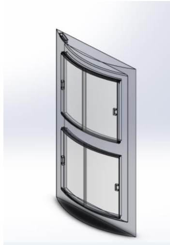
Şekil 41. Açılabilir Kavisli Sürgülü Dört Bölmeli Şeffaf Kapak Tasarımı
