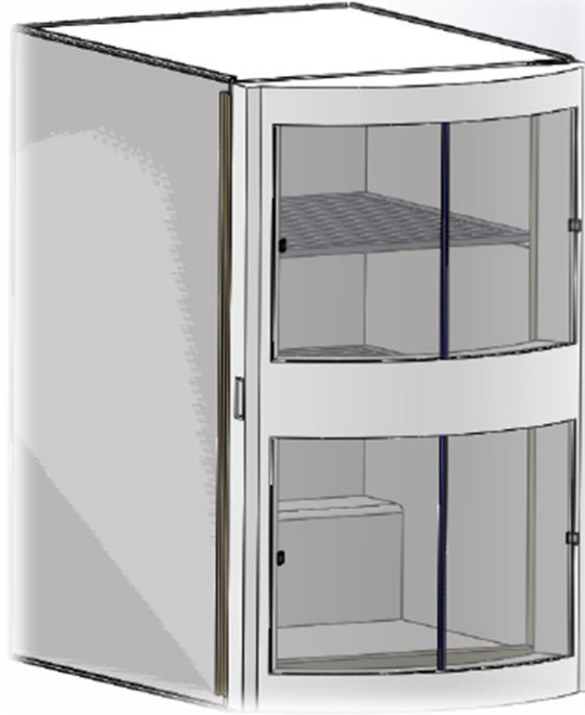
Şekil 55. Sensörlü Şeffaf Kapak Buzdolabı Tasarımının Üç Boyutlu Montaj Resmi
