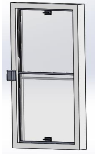
Şekil 45. Açılabilir Dikey Sürgülü İki Bölmeli Şeffaf Kapak Tasarımı
