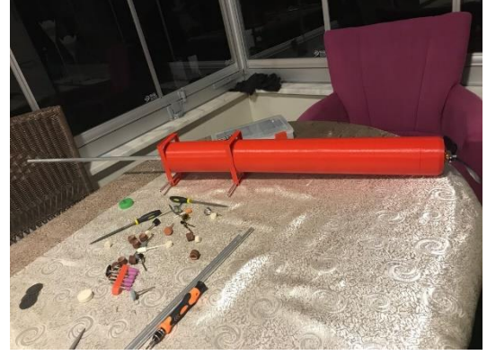
Şekil 12-13: Ana gövdenin 3D printer kullanılarak üretilmesi
