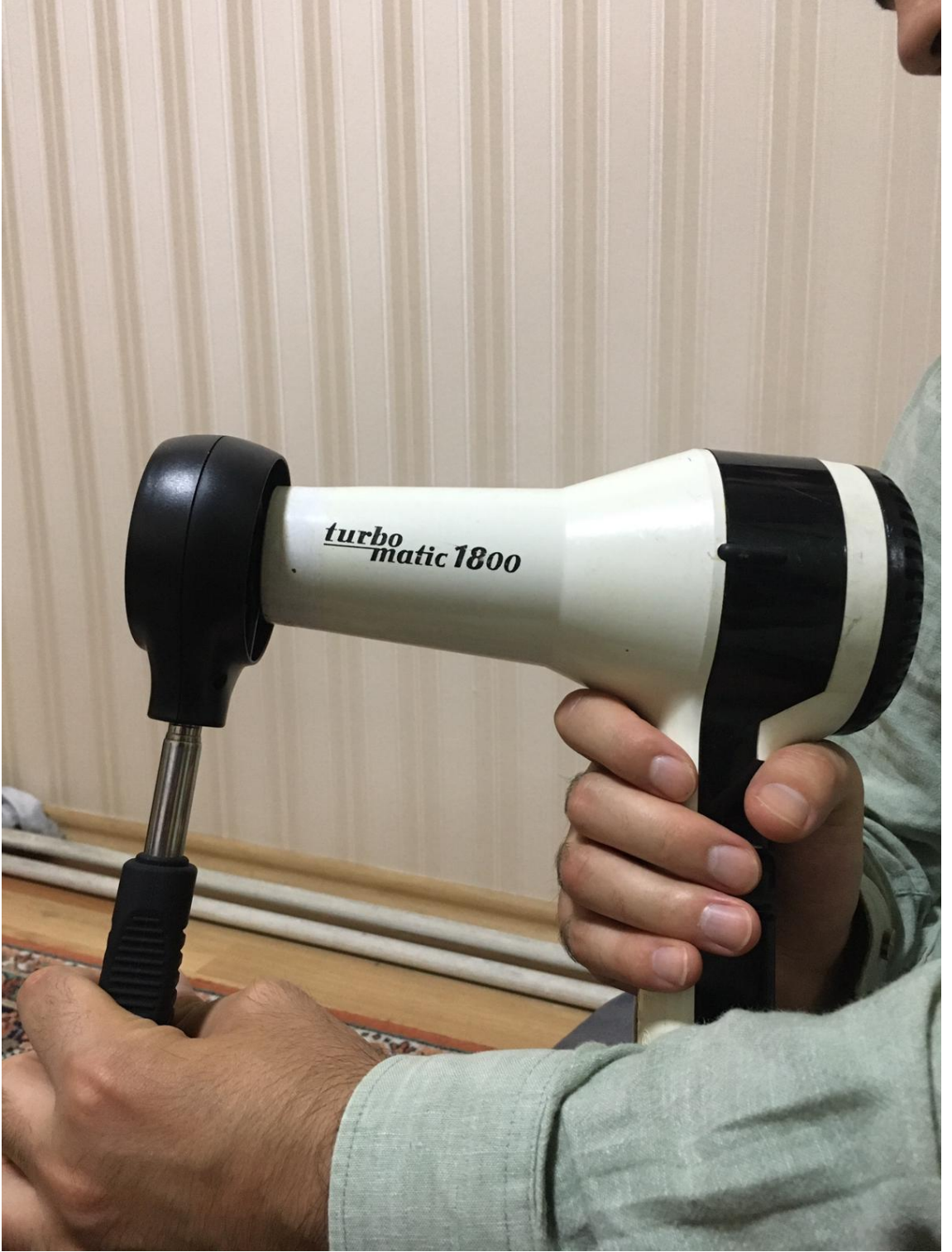
7.2 Sıcak havanın ölçümü için anemometrenin konumlandırılması
