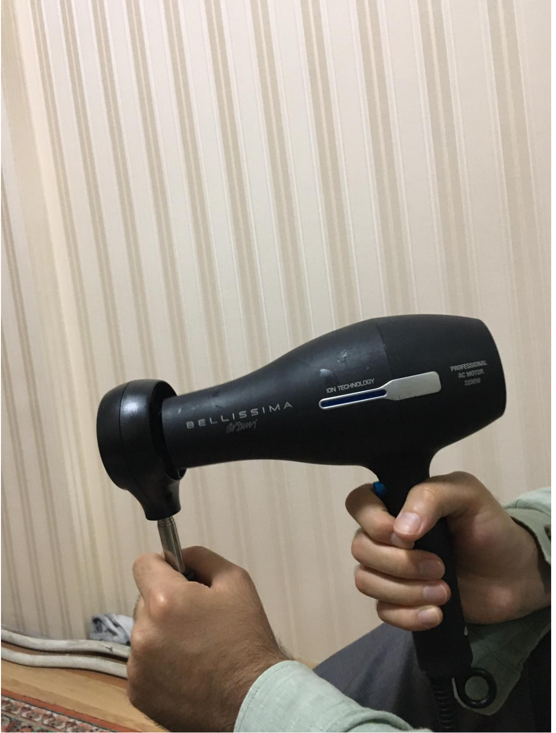
8.1. Soğuk havanın sıcaklık değeri ve hızının ölçümü için konumlandırılması
