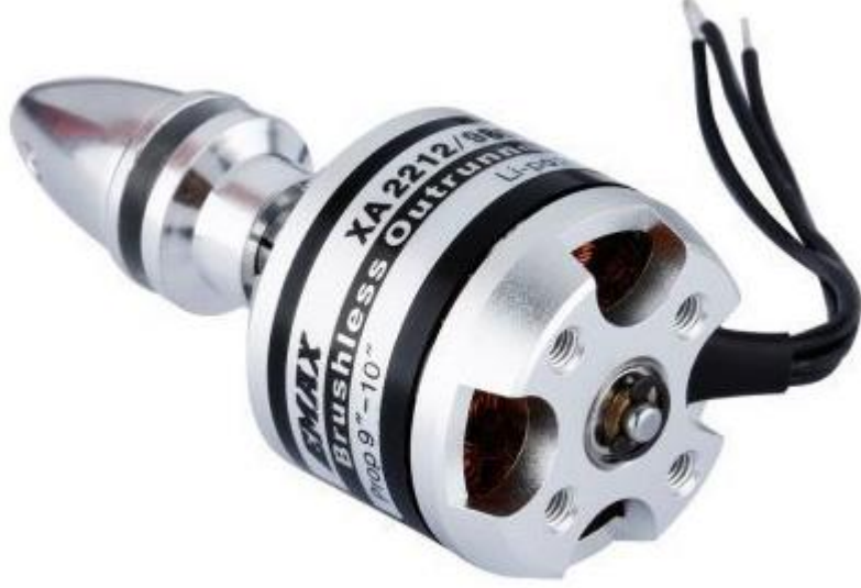
Şekil 28.Kullandığımız Emax XA2212 980KV 3S Fırçasız DC Motor
