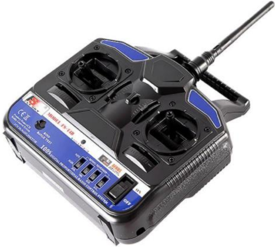
Şekil 32. Flysky FS-T4B 2.4Ghz 4 Kanal Kumanda
