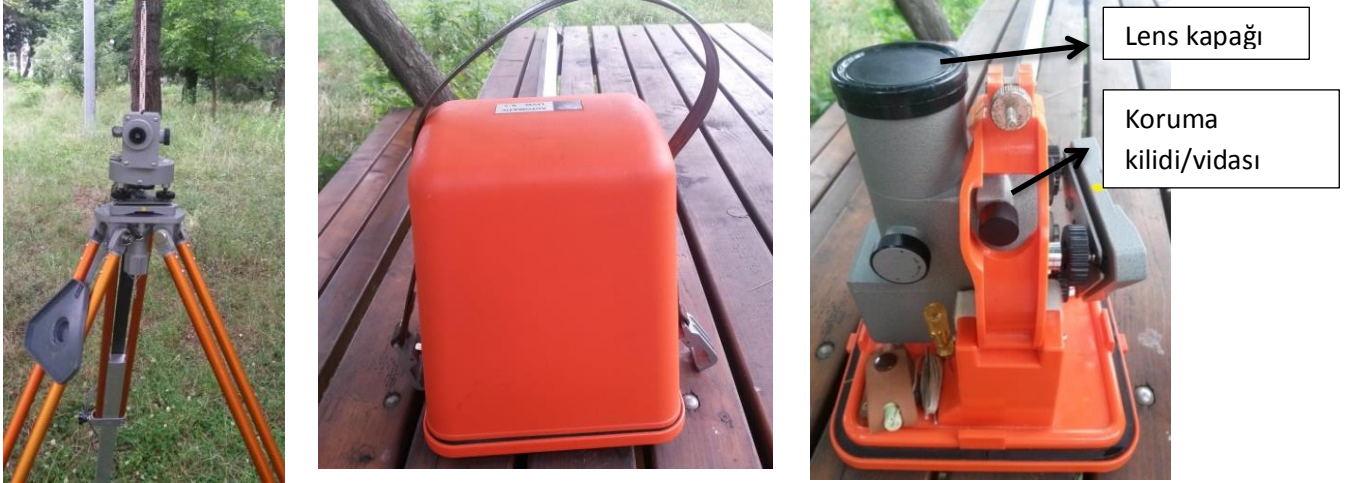
Şekil 1. Nivo aletinin genel görünümü
