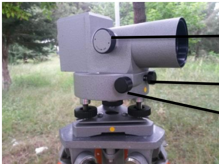
Şekil 4. Nivo üzerindeki ayar vidaları
