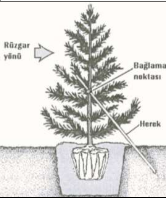
Fidanların kazık ve tel gergiler yardımıyla desteklenmesi
